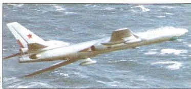
Captado en su ambiente operativo, este Tu-16 se aleja de su perseguidor. Los abombamientos del fuselaje y las barquillas subalares le identifican como un «Badger-F», usado para calibrar las defensas de la OTAN.
